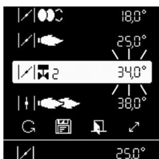
Когда пламя обнаружено и стабилизировалось, горелка устанавливается на работу на 1<sup>ой</sup> ступени по истечении времени безопасности.
